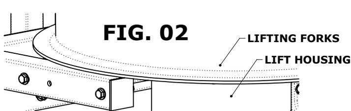
**STEP 02: ROLL THE CART INTO POSITION UNTIL THE LIFTING FORKS ARE AROUND THE LIFT HOUSING. THERE SHOULD BE ABOUT A 1/2" SPACE BETWEEN THE BACK OF THE LIFT HOUSING AND THE CART. CONNECT THE STAP HOOKS THROUGH THE EARS OF THE LIFT (FIG. 03)**
