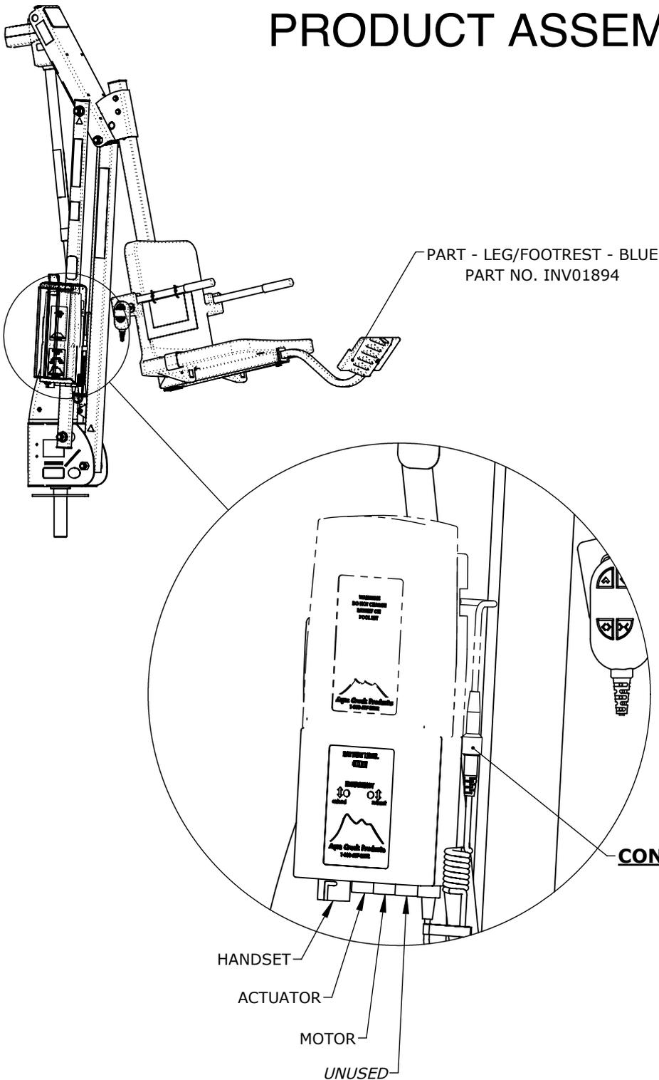
STEP 4) REMOVE THE FULLY CHARGED BATTERY FROM THE CHARGER AND INSTALL THE BATTERY TO THE CONTROL BRACKET, ON TOP OF THE CONTROL BOX. ONCE SECURE, CONNECT THE BATTERY CABLE TO THE CONTROL BOX CABLE. THE LIFT WILL ONLY OPERATE WHEN THE BATTERY IS CONNECTED PROPERLY.
