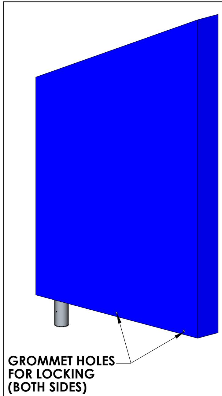
**COVER IS OVER THE LIFT; USE LOCKS THROUGH GROMMET HOLES TO SECURE SAFELY.**
